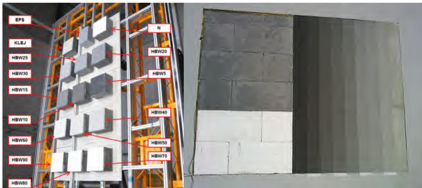
Фото 1. Лабораторний і польовий стенд для дослідження температур на різних поверхнях.
