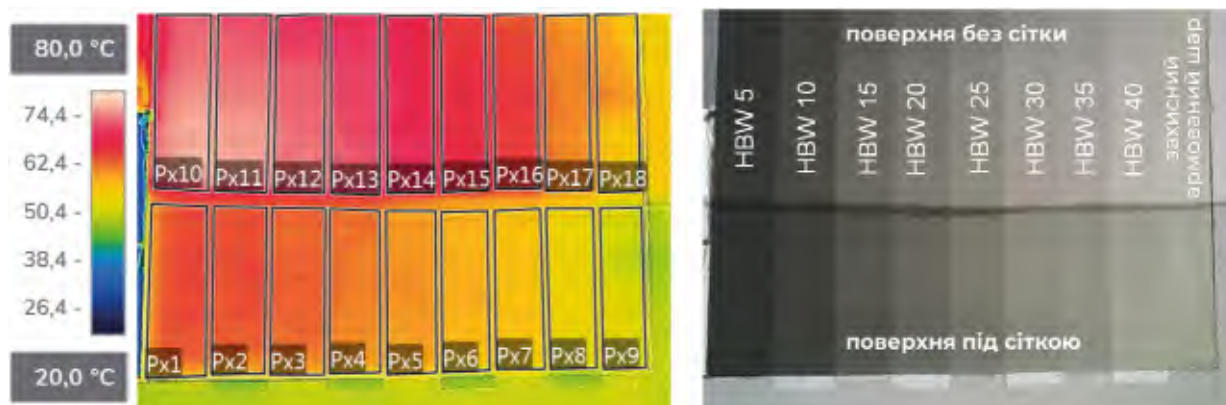
Фото 2. Термограма та фото стіни з поверхнями різного HBW та захисним армованим шаром — у системі ETICS із застосуванням EPS Graphite — нижня частина захищена сіткою, верхня частина без захисту сіткою [5].
