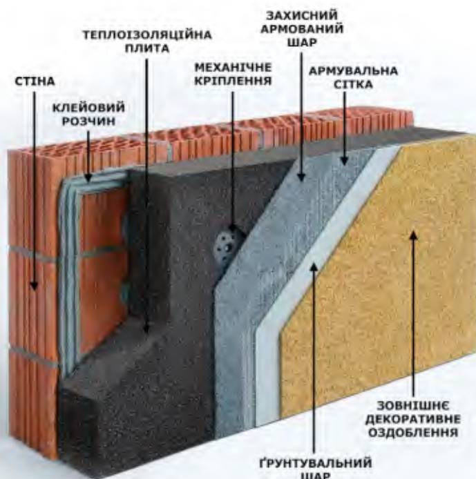
Схема ETICS з графітовим пінополістиролом (External Thermal Insulation Composite System)
