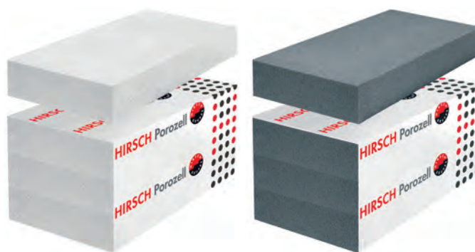
Рис. 5 Плити утеплення EPS прямокутної форми виготовляються методом блочного формування з подальшою порізкою блоків у потрібний формат (білого кольору звичайні та сірі графітонаповнені)
