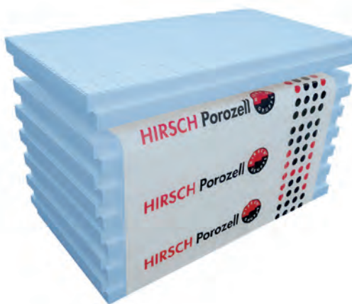
Рис. 2. Для зовнішнього утеплення фундаментів плити EPS виготовляються методом індивідуальної фасонної формовки із симетричним пазуванням торців («замки» для перекриття стиків) та спеціальним дренажним рельєфом на зовнішньому боці
